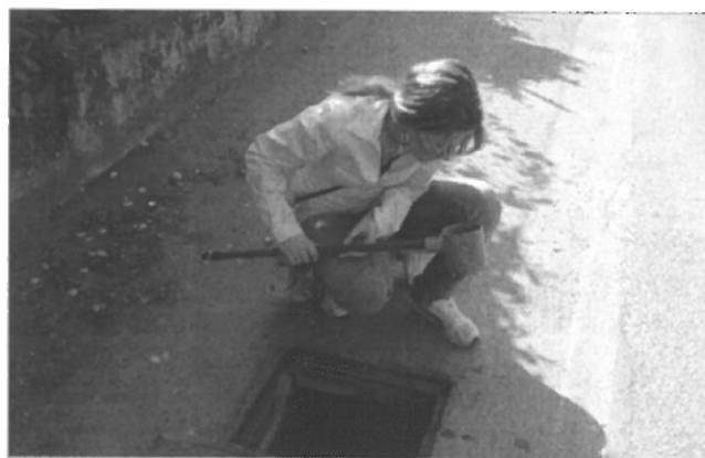
Campionamento pozzetto stradale
